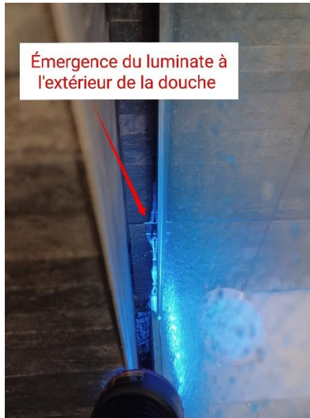
Test d'aspersion avec luminate sur paroi de douche.
